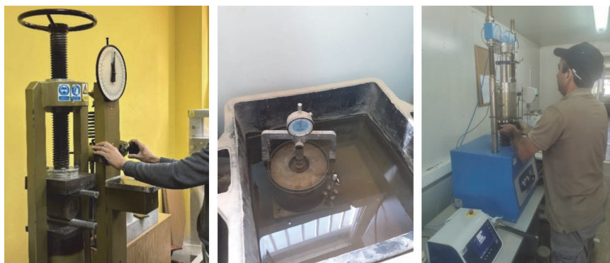
Slika 5. Laboratorijsko ispitivanje ITS (lijevo) i CBR indeksa s određivanjem linearnog bubrenja (sredina i desno)
