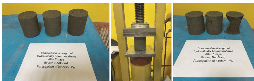
Slika 4. Uzorci stabilizirani sa 7 % BB veziva prije (lijevo), tijekom (sredina) i nakon (desno) ispitivanja tlačne čvrstoće nakon 7 dana njege
